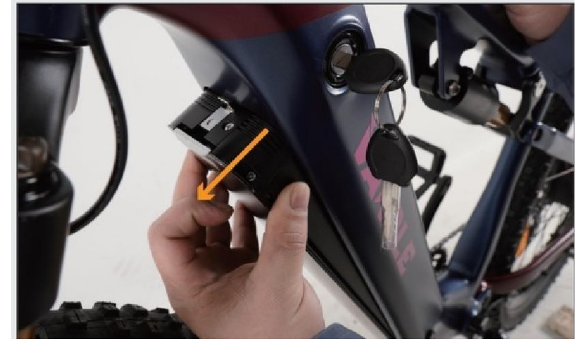
03 Entfernen Sie die Batterie (wie in der Abbildung gezeigt).
