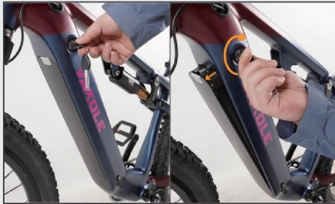
01 Stecken Sie den Schlüssel in das Schlüsselloch.. Drehen Sie den Akku im Uhrzeigersinn, um ihn zu entriegeln.
