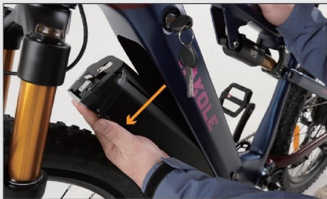
04 Entfernen Sie die Batterie (wie in der Abbildung gezeigt).
