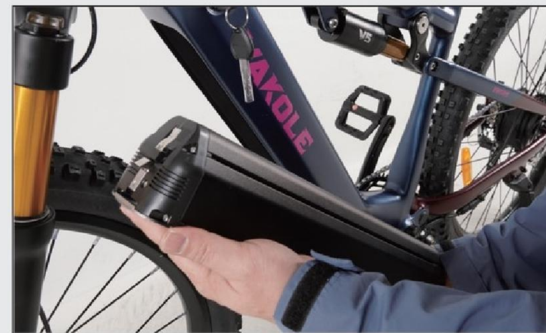
05 Entfernen Sie die Batterie (wie in der Abbildung gezeigt).
