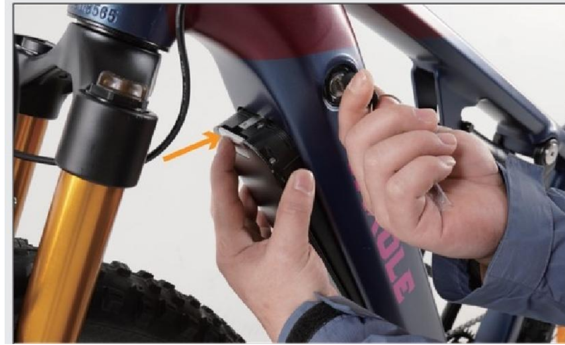
02 Drücken Sie den Knopf am Akku (wie in der Abbildung gezeigt), um den Akku vollständig zu entriegeln.
